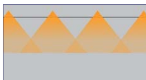
Zvočniki z nizko usmerjenostjo v prečnem prerezu - za enakomerno pokrivanje prostora
